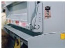
Pestillos de compuerta de acero
